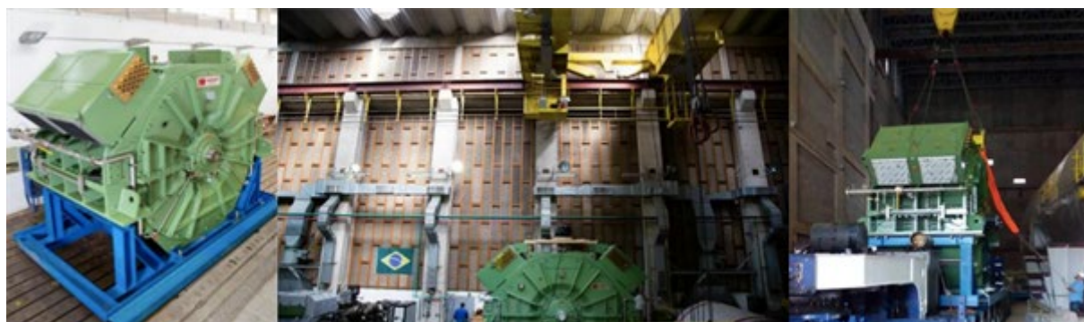
Figura 22: Fotos de Motor de Ímãs Permanentes para propulsão de grande porte (Fonte: AMAZUL, disponível em https://www.amazul.mar.mil.br , acessado em 27/11/2020)
