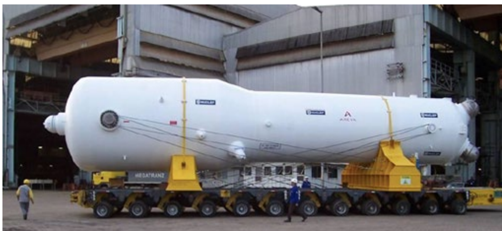
Figura 17: Artefato de caldeiraria pesada fabricado pela Nuclep (Fonte: NUCLEP, disponível em https://www.nuclep.gov.br/pt-br/produtos-servicos/setor-nuclear , acessado em 04/12/2020)
